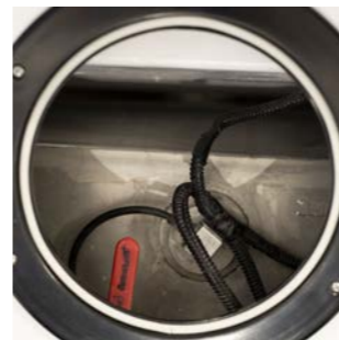
Bränsletanken av rostfritt stål, nås via inspektionsluckan framför aktersoffan.
